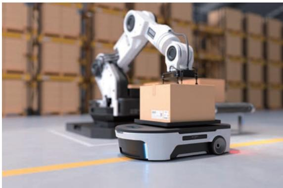
電動バルンサ、これまで工場や倉庫などで人が行っていた搬送作業を代わりに行えるAGV（無人搬送車）、さらには目的とする場所まで自律移動が可能なAMR（自立走行搬送ロボット）などが数多くリリースされ、「搬送助力」の分野はますます活況を呈している。
