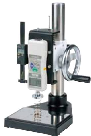
フォースゲージと、測定物に合わせた治具を取り付けることで、簡易試験機として様々な荷重試験が可能に。
