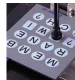
RFを使用した複数測定箇所の連続試験例
