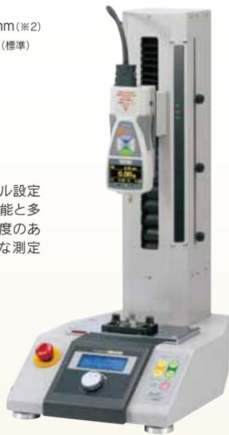
押しこみ/引張量のデジタル設定や動作パターンのメモリ機能と多機能なモデル。また、より強度のある構造で、変位のより精密な測定が可能となります。
